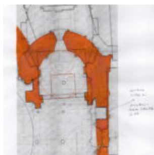
Fig. 1. Otranto, cattedrale, navata destra, ricostruzione della planimetria originaria per sovrapposizione del piano
